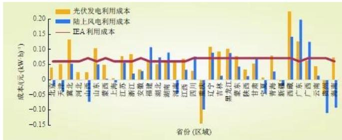
图 7 2025 年陆上风电、光伏发电利用成本 CAA发电自动化
